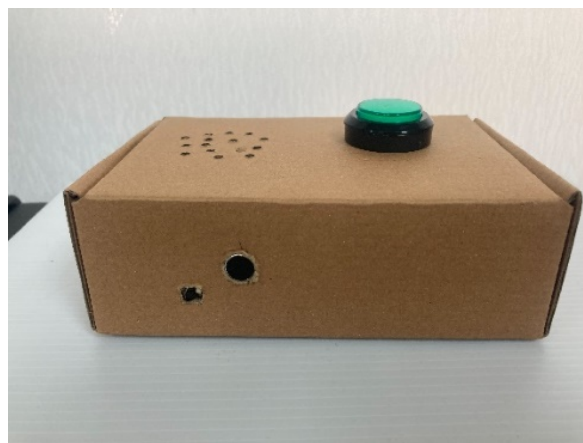
圖 28 紙盒版錄音 ATD 自製孔洞大小不合，外觀上待加強
