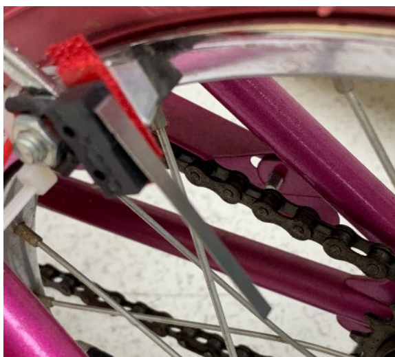
圖 13 車體安裝微動開關。
