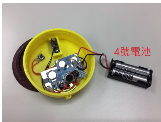
圖 13 錄音 ATD 改裝電池盒
