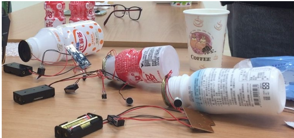
圖 24 以養樂多、優酪乳空瓶製作音箱
