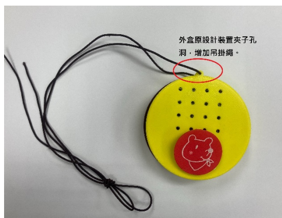
圖 16 原設計之錄音 ATD 增加吊掛繩
