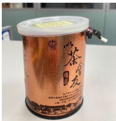
圖 21 鐵罐製錄音 ATD， 按鍵開關不易配置擺放
