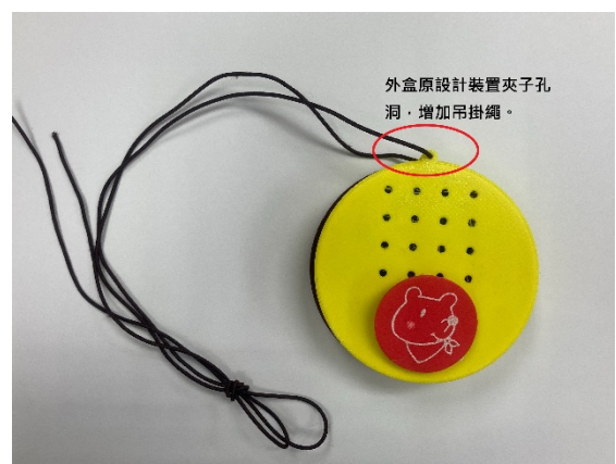
圖 16 原設計之錄音 ATD 增加吊掛繩
