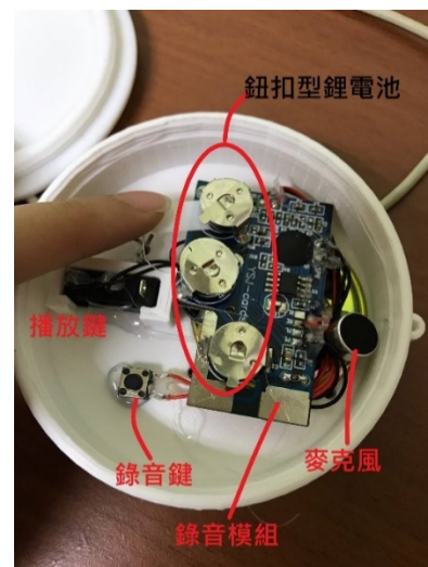
圖 10 錄音 ATD 第一代內部構造
