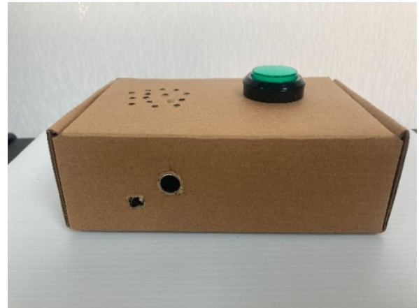
圖 28 紙盒版錄音 ATD 自製孔洞大小不合，外觀上待加強
