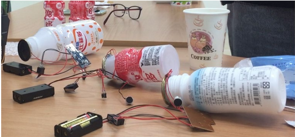
圖 24 以養樂多、優酪乳空瓶製作音箱
